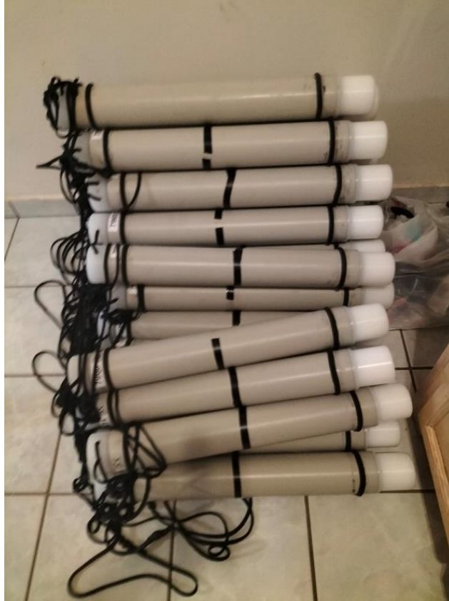
Figura 5. Detectores acústicos tipo F-POD listos para colocar en los sitios de muestreo con anclajes.
